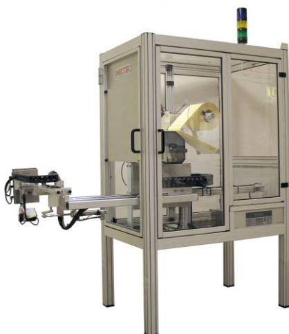
To- eller tre- sidet palleetikettering. Et stop eller to stop af pallen. Tre-sidet tre stop af pallen.
