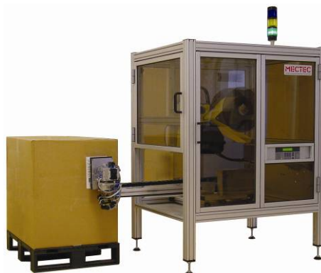
DC-600-W Lukket stativ i alu- profiler for to-sidet palleetikettering. 1 stop af palle.
