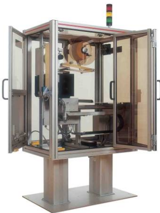
Lukket stativ i alu-profil og automatisk justerbar i højden.
